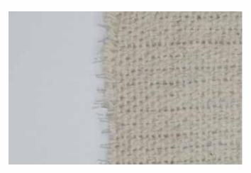
L'acier spécial est travaillé et tissé avec le coton, ce qui rend le tissu extrêmement robuste. En cas d'humidité, il ne forme pas d'oxydes. Ce dernier point représente un avantage par rapport au cuivre p. ex.
