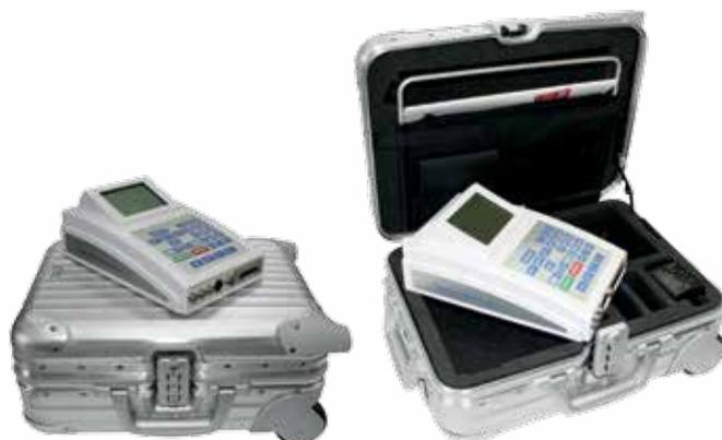
La mallette Rimova permet également de ranger le Rayotensor, le gobelet mesureur et le gobelet protégé, 4 détecteurs tissu de 30 cm, des Green-Card RAH ainsi que des détecteurs pointeur ou boule.
